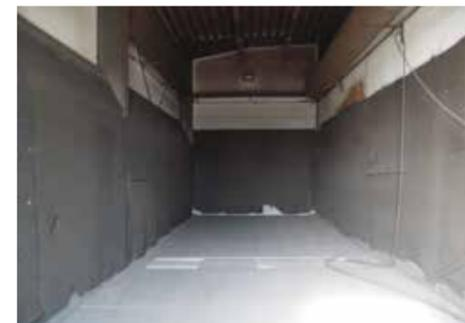
Mit einer Sandstrahlanlage auf einer Fläche von 90 m<sup>2</sup> können wir auch große Bauteile mit einer Länge von bis zu 15 m bearbeiten.
