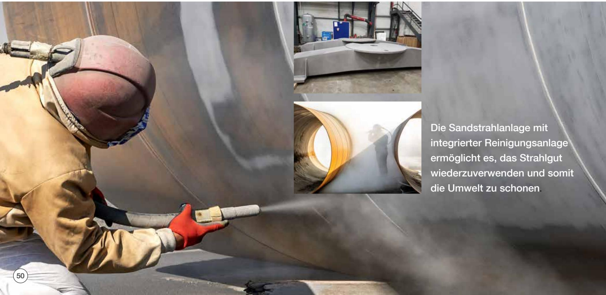
Die Sandstrahlanlage mit integrierter Reinigungsanlage ermöglicht es, das Strahlgut wiederzuverwenden und somit die Umwelt zu schonen.
